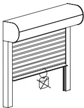
Belasten Sie den Rollladen nicht mit zusätzlichen Gegenständen. Dies kann zur Beschädigung oder zum Absturz des Rollladens führen.
