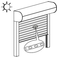
Bei Verwendung von Rollläden als Sonnenschutz empfehlen wir Ihnen, diese nicht vollständig zu schließen, so dass eine Hinterlüftung gewährleistet ist.
