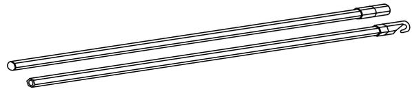
Ab einer Stablänge von 1350mm besteht der Bedienstab aus mehreren Teilstücken und Verbindern.
