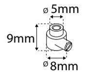
Halterung für Fensterflügelmontage (geklemmt) mit Klemmträger
