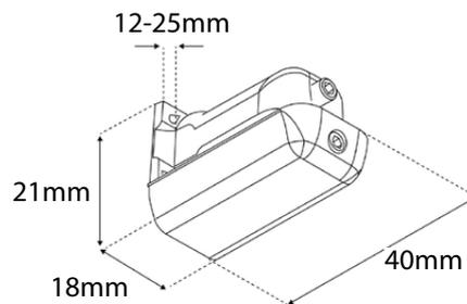
Halterung für Fensterflügelmontage (geklemmt) mit Klemmclip
